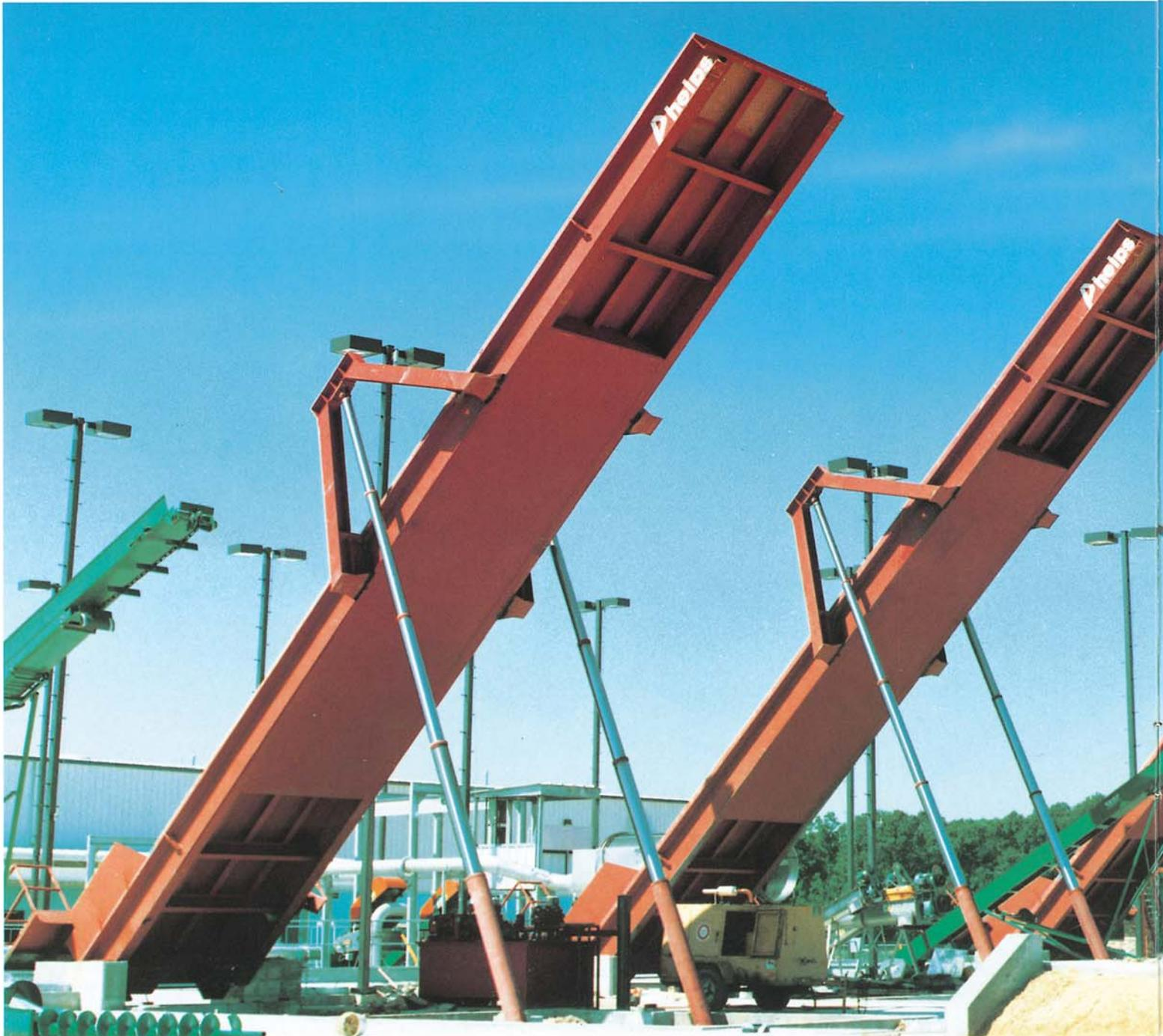
La plataforma metálica se embarca como una sola pieza sobre un trailer plano hasta el sitio de operación del volcador directamente en donde se efectúan las maniobras de sentarla inmediatamente sobre el concreto preparado así para evitar mayor gastos de instalación.
