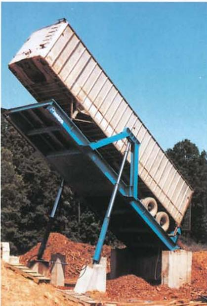
camiones o trailers sobre la plataforma durante el proceso de descarga. Estan cuidadosamente diseñados y construidos para soportar la carga contra ellos y compensar cualquier desalineamiento del camion o el trailer en la plataforma.
