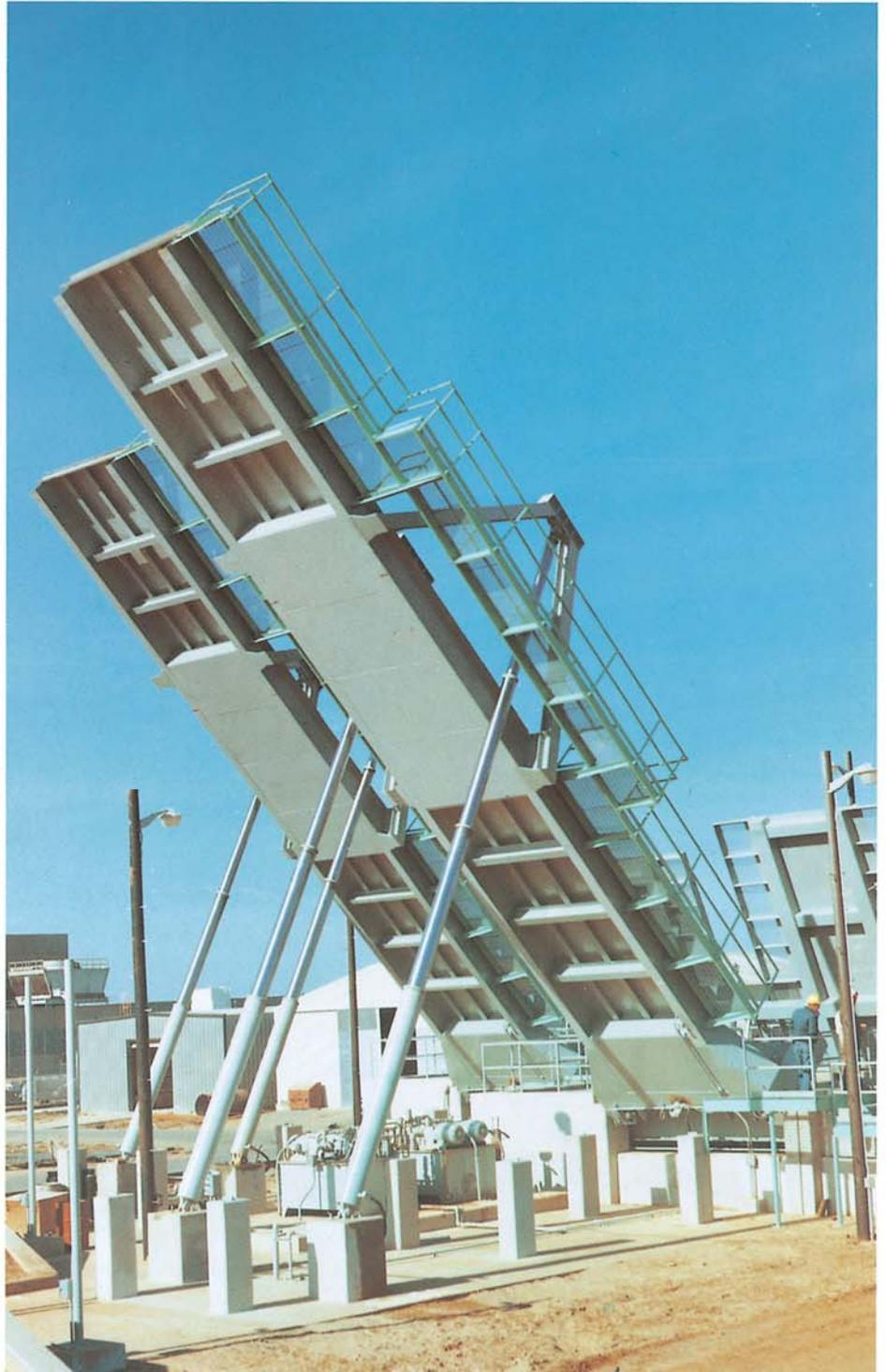
de la descarga de la plataforma, o tambien se puede instalar una tolva de recepcion completamente sobre el nivel del terreno o se instala con cierta altura sobre mismo nivel para efecto de reducir la excavacion en el terreno.
